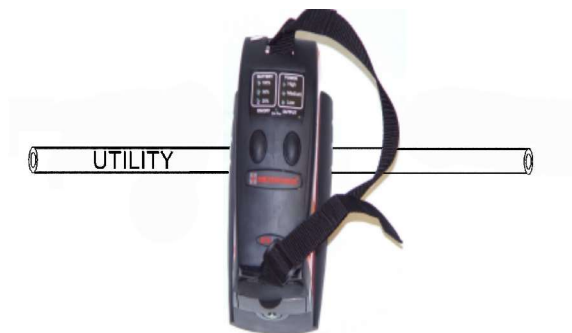
Figur 6-3: Plassering av senderen ved induktiv søking
