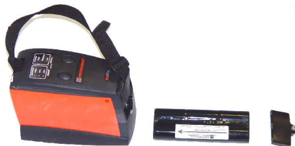
Figur 8-2: Bytte fra D-celle batterier til NiMH batteri-pakke
