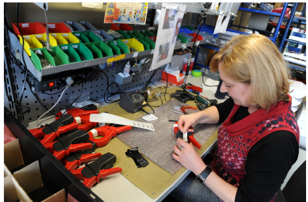
Montering av måletenger for faseutvelgelse.
