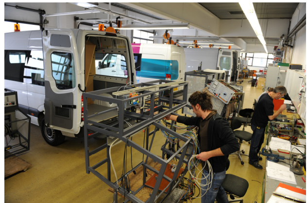
Montering av Seba KMT kabelmålebiler.
